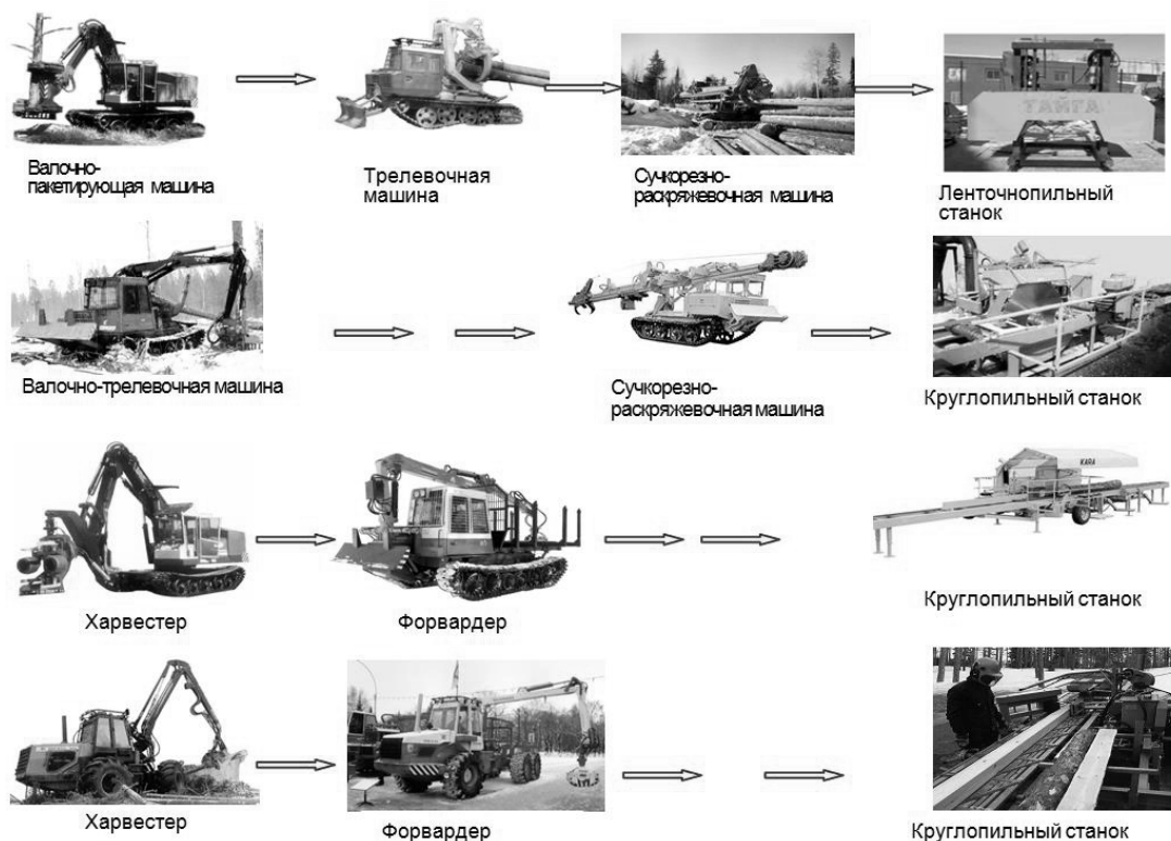
Рис. 2. Возможные варианты компоновки технологических машин и оборудования для получения пиломатериалов на лесосеке
